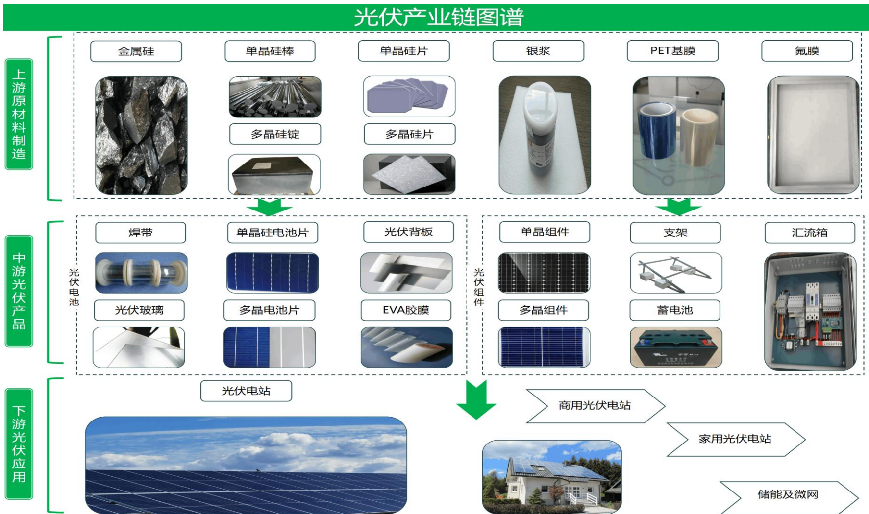
图 5-2 光伏产业链图谱
